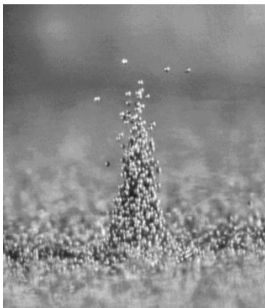
ábra 2: Rezgetett vékony granuláris rétegben kialakuló lokalizált állóhullám, úgynevezett oszcillon . A szemcsék 0.15 - 0.18 \text{ mm} -es bronzgolyók, a rétegvastagság 17 részecskényi. Az oszcillonok megjelenéséhez kísérletet vákuumban kell végrehajtani, a rezgés amplitudóját és frekvenciáját egy adott szűk tartományban kell beállítani. [2]
